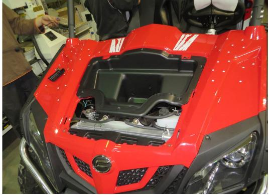
TAKE OUT THE RUBBER PLUGS FROM HEATER TUBES.
